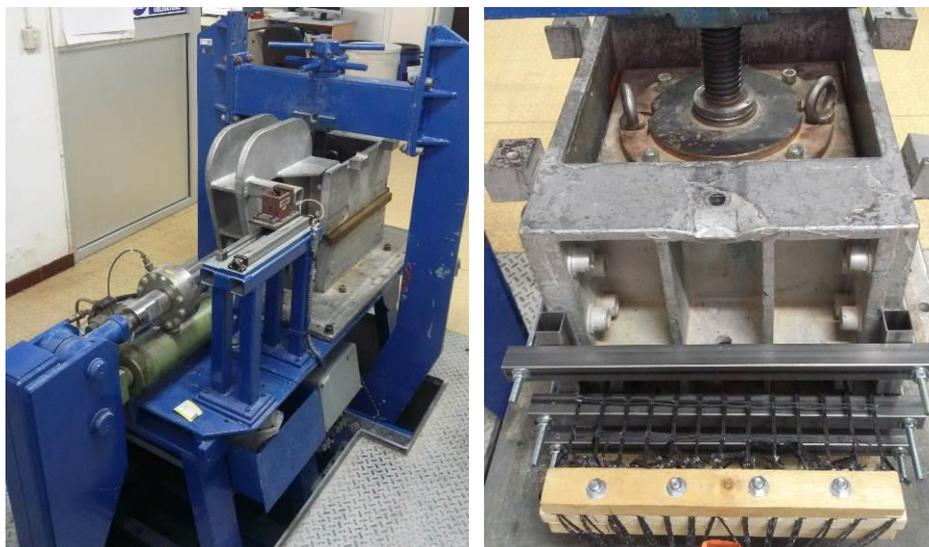
Figure 3. Dispositif d'essais en configuration « essai de cisaillement direct » (photo de gauche) et en configuration « essai d'extraction » (photo de droite).
