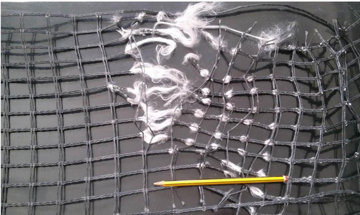
Figure 10. Photographie de la géogrille après essai d'extraction pour la contrainte de confinement 150 kPa.
