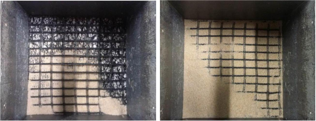
Figure 5. Dans la boîte de cisaillement, mise en place de l'interface inférieure géogrille/sable avec le sable inclus dans la structure filamentaire 3D (photo de gauche) et mise en place de l'interface supérieure géogrille/sable (photo de droite).
